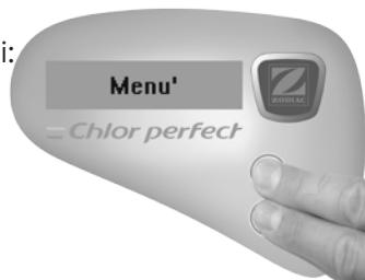
→ Per uscire dal menù « Parametri », premere il tasto « SET/Esc » e selezionare « Sì » o « No » tramite i tasti di navigazione «  $\blacktriangle$  » e «  $\nabla$  » per salvare o meno le nuove impostazioni. Convalidare la scelta premendo il tasto « CAL/Enter ».
