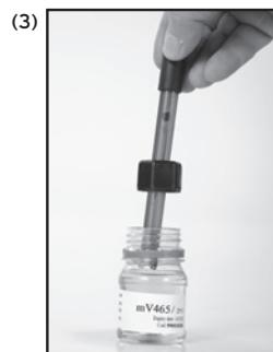
3. Immergere la sonda nel flacone di soluzione tampone « mV465 ».
